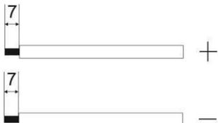
1. Зачистить от изоляции положительный и отрицательный провода на 10 мм.
